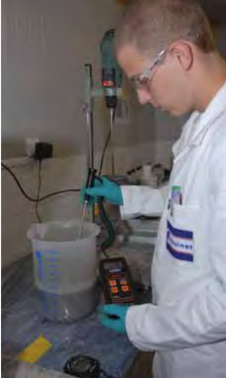
Formulación de la lechada de cemento en el laboratorio de Freyssinet
