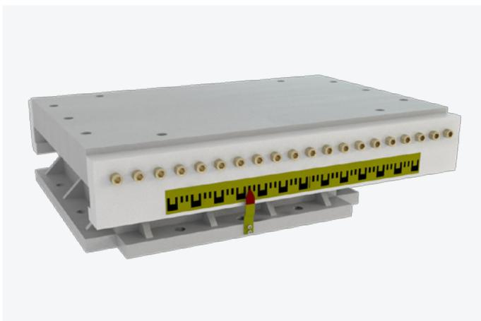
Es posible ajustar la posición de las placas deslizantes de los apoyos deslizantes para permitir los movimientos irreversibles, como la retracción y la fluencia. Esta opción permite reducir las dimensiones de las placas deslizantes.
