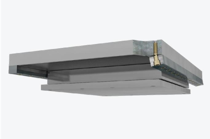
El principio del tope fusible consiste en bloquear el movimiento del apoyo hasta una fuerza dada y liberarla después. La guía del apoyo se fija con fusibles especialmente concebidos. Esta técnica sirve para limitar las fuerzas sísmicas que impactan contra las estructuras.
