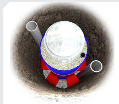
Corte de la longitud empotrada de un anclaje con un tubo de inyección
