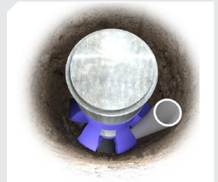
Corte de la longitud empotrada de un anclaje con un tubo de inyección
