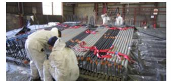
Producción de anclajes de barra permanentes
