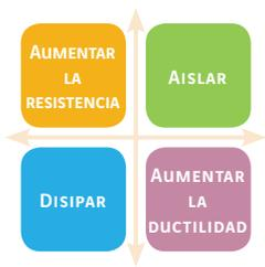
La estrategia de reparación o de refuerzo debe adaptarse a la naturaleza de la estructura. Por ejemplo, durante un terremoto, las estructuras de hormigón armado de gran altura porticadas son bastante flexibles y trabajan en flexión, mientras que las estructuras de poca altura con forjados de hormigón funcionan principalmente a cortante.
