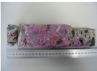
Ensayo con fenolftaleína del PH del hormigón
